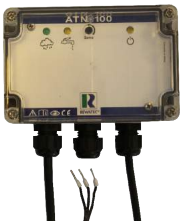
Rewatec boks med frakoblede ledninger
