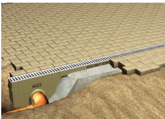
5. Genetablér belægningssten. Bemærk overkant af belægningssten skal være 3-5 mm over riste overkant
