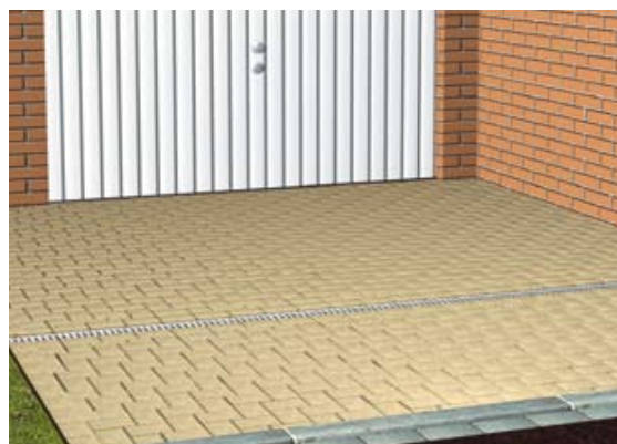
6. Færdigmonter liniedræn. Må først ibrugtages og overkøres når betonen er gennemhærdet
