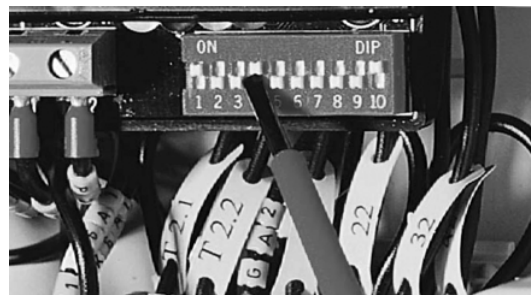
Fig. 13 Indstilling af DIP-switches på CU 2xx
