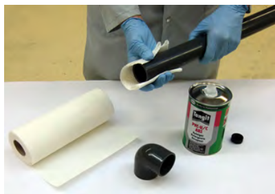
Rengøring af rør og muffe
