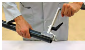
Affasning af rør
